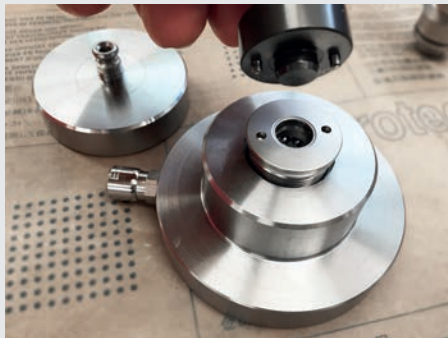
Inserire STARK.basic.Y nel foro di installazione
