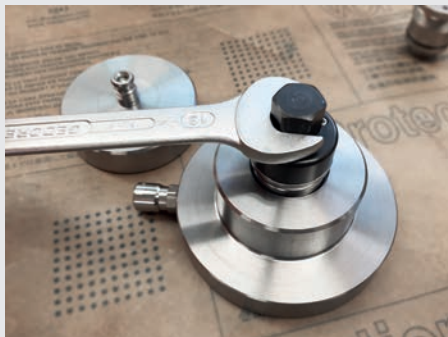
Serrare con la chiave di montaggio (15 Nm)
