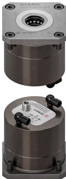
Bloccaggio rapido in acciaio per utensili altamente legato o alluminio anodizzato ad alta resistenza. Il sistema è a semplice effetto pneumatico (bloccaggio tramite forza della molla) ma dispone di una moltiplicazione pneumatica della forza di bloccaggio facoltativa.
