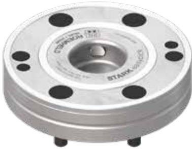
Bloccaggio rapido in acciaio per utensili altamente legato. Il sistema è a semplice effetto pneumatico (bloccaggio tramite forza della molla).
