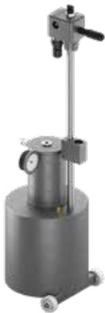
Il moltiplicatore di pressione serve all'attivazione dei sistemi di bloccaggio a semplice effetto. Il moltiplicatore trasforma la pressione pneumatica in pressione idraulica e si presta ad impieghi con pressioni di 80 bar.
