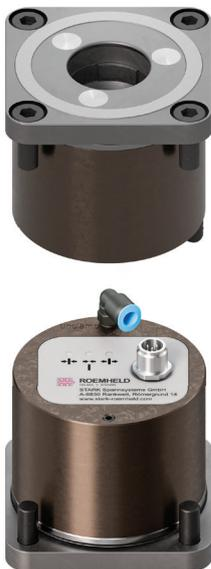
Elemento di bloccaggio in acciaio inox per utensili altamente legato o alluminio anodizzato ad alta resistenza. Il sistema è a semplice effetto pneumatico (bloccaggio tramite forza della molla).
