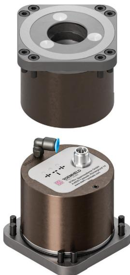
Elemento di bloccaggio in acciaio inox per utensili altamente legato o alluminio anodizzato ad alta resistenza. Il sistema è a semplice effetto pneumatico (bloccaggio tramite forza della molla).
