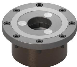
Elemento di bloccaggio in acciaio per utensili altamente legato o in acciaio inox. Il sistema è a semplice effetto pneumatico (bloccaggio tramite forza della molla).
