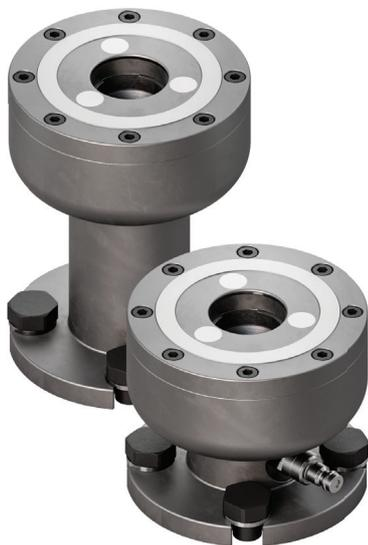
Elemento per montaggio esterno con corpo rialzato  $\varnothing 100$  mm comprensivo di STARK.airtec S5000-104. Parte inferiore con sporgenza  $\varnothing 12$ . 4x posizioni di fissaggio per viti M12 su reticolo di 40 mm. Giunto rapido pneumatico laterale per lo sbloccaggio.
