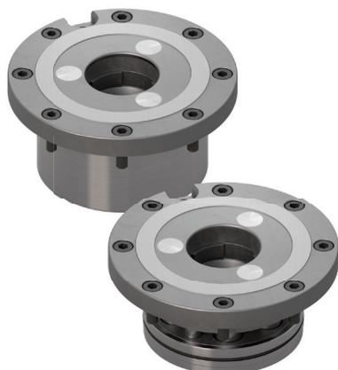
Elemento di bloccaggio in acciaio per utensili altamente legato o in acciaio inox. Il sistema è a semplice effetto pneumatico (bloccaggio tramite forza della molla).
