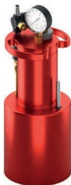
Il moltiplicatore di pressione serve a pilotare sistemi di bloccaggio a semplice effetto. Il moltiplicatore RECORD trasforma la pressione pneumatica nella pressione idraulica necessaria per sbloccare gli elementi STARK.classic.NG.
