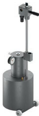
Il moltiplicatore di pressione serve a pilotare sistemi di bloccaggio a semplice effetto. Il moltiplicatore trasforma la pressione pneumatica in pressione idraulica e si presta ad impieghi con pressioni di 40 bar.
