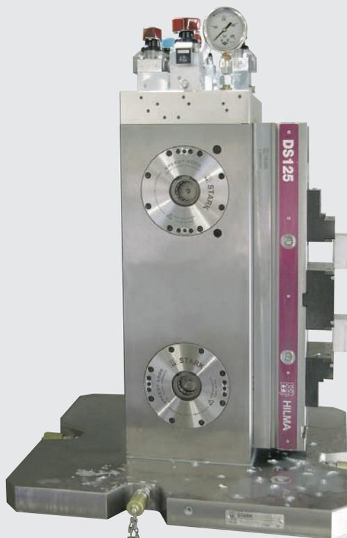
Bloccaggi rapidi STARK.classic.2 montati con elementi di passaggio fluidi su ciascun lato della torretta di bloccaggio. Il comando delle morse da macchina HILMA avviene tramite valvole di comando nella parte superiore della torretta.
