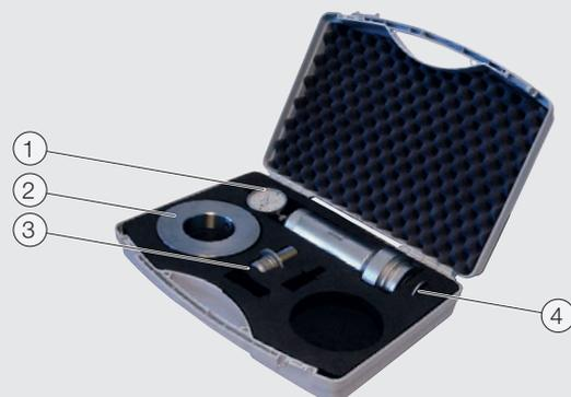
Dispositivo per il controllo della forza di bloccaggio (1) con certificato di calibrazione ed istruzioni per l'uso nella valigetta in plastica, con anello di appoggio (2), adattatore perno di bloccaggio (3) e rosetta distanziale (4).
