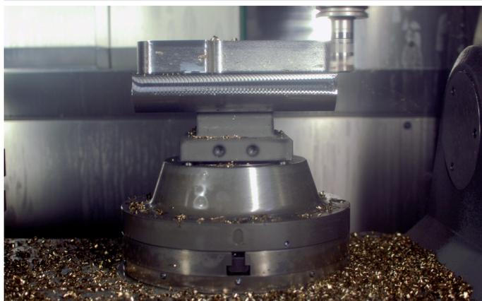
Rigidezza estremamente elevata grazie ad un accoppiamento di forma senza gioco ed alla elevata forza di precarico delle molle a tazza (elementi a sbloccaggio idraulico) oppure delle molle a spirale (elementi a sbloccaggio pneumatico)
